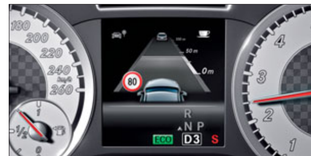
Lo Speed Limit Assist compare sia sul quadro strumenti che sul display centrale del COMAND Online.
