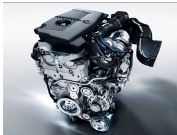
Il motore a benzina a 4 cilindri A 180 è dotato di iniezione diretta mediante piezo-iniettori e di sovralimentazione turbo.
