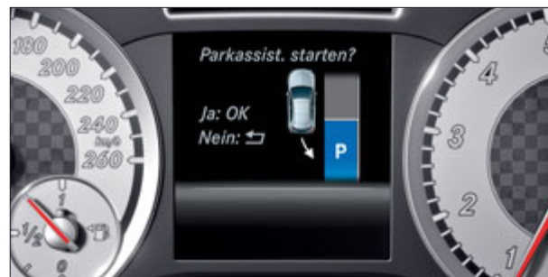
Il display nella strumentazione fornisce al guidatore un quadro della situazione sulla manovra di parcheggio in corso.
