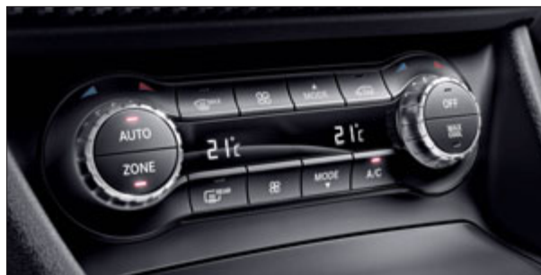
Il COMFORTMATIC (a richiesta) assicura una gradevole temperatura dell'abitacolo.
